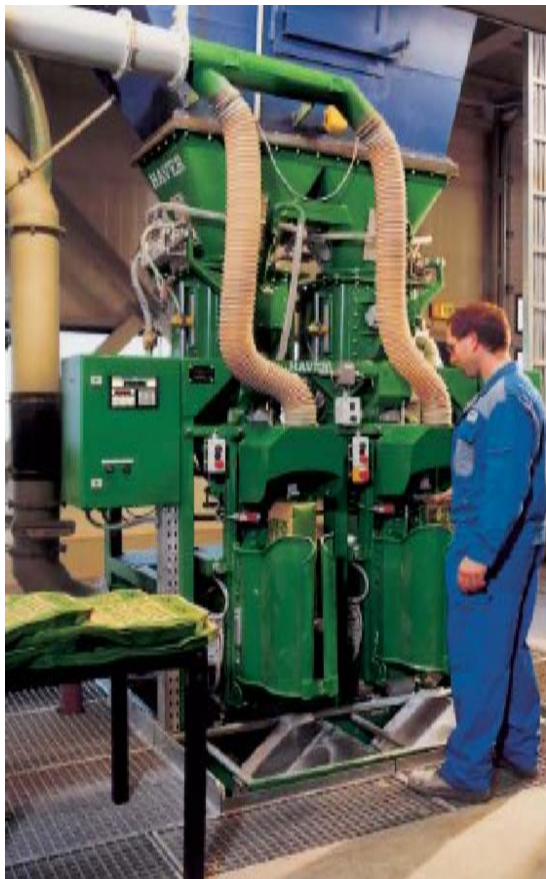
Машина фасовки HAVER клапанных мешков с воздушной системы фасовки с вертикальной автоматической системы сброса мешков.
