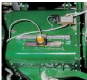
Камера давления с окном и индикатором уровня наполнения.
