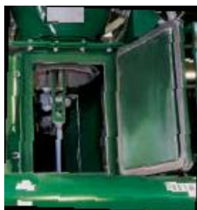
Дверца обслуживания на камере давления.
