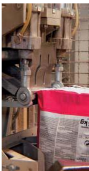
Ультразвуковая система сварки клапанных мешков.
