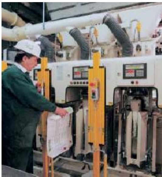
Машина фасовки в клапанные мешки фирмы HAVER с системой ультразвуковой сварки мешков.
