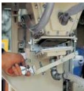
Дверце обслуживания на головке наполнения.
