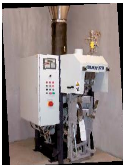
Машина фасовки HAVER клапанных мешков с горизонтальным расположением турбины наполнения.
