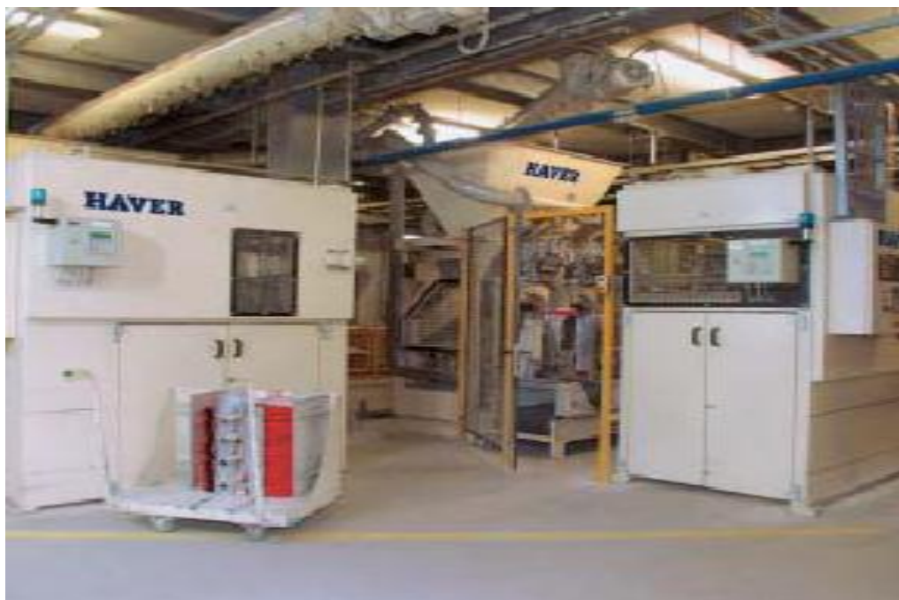
HAVER-Автоматическая установка для насадки клапанных мешков COMPACT.
