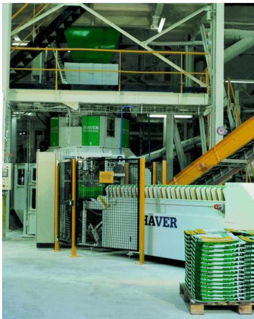
Автомат для насадки мешков HAVER RADIMAT фундамент высокой производительности фасовки.
