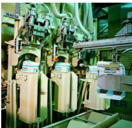
HAVER фасовочная установка в клапанные мешки с автоматом насадки.
