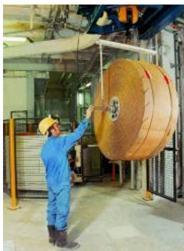
Подъем бобины пустых мешков для автомата RADIMAT модификация магазин бобина.
