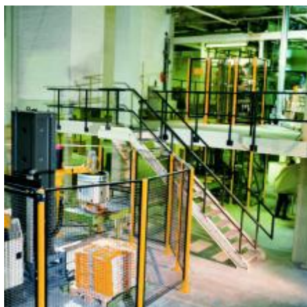
HAVER фасовочная установка с системой разгрузки паллет.
