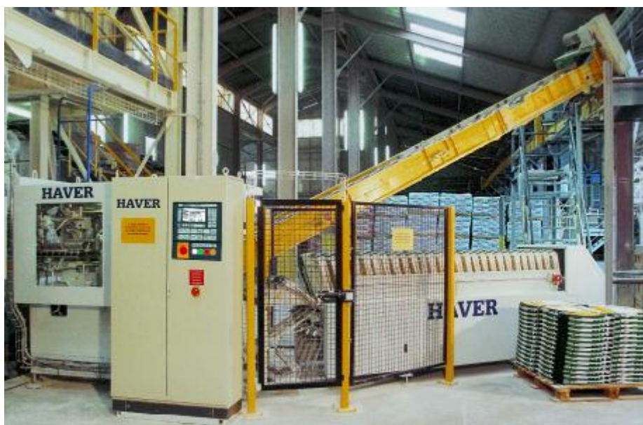
Автомат RADIMAT для насадки мешков с магазинов «пачка» и автоматической доставкой мешков.
